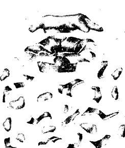
Das Geschoß deformiert sich schnell mit starker Stoßwirkung. Immerhin reicht die Verzerrung zum Durchschlag mittelstarker Knochen- und Muskelpartien aus (sofern nicht Schuß im spitzen Winkel!). Viele wirksame Splitter in Einschußnähe. Unter Umständen vollständige Zerlegung bis auf den Geschoßboden und vielleicht einen kleinen Bleirest. Starke hydrodynamische Wirkung und größte Aufhaltekraft.
